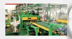
入料厚度 Thickness: 0.4-12, 入料宽度 Width: 650-2024, 入料长度 Length: ; 钢卷 开平
